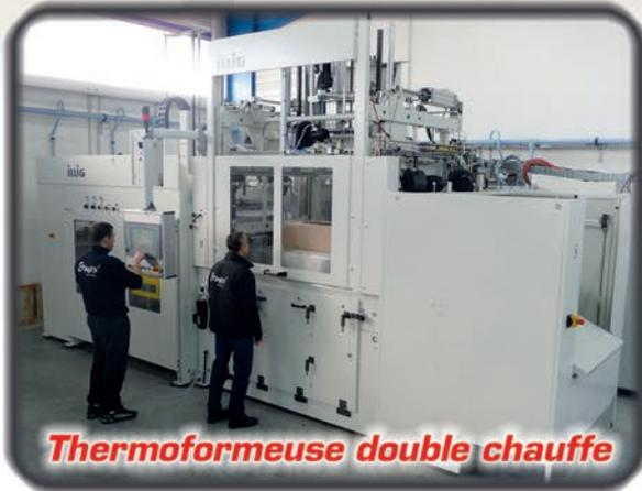
**Thermoformeuse double chauffe**
